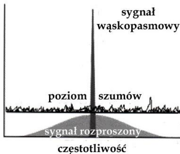
Rys. 1.2. Transmisja sygnału o rozproszonym widmie. Sygnał użytkowy jest po stronie nadawczej rozpraszany, a po stronie odbiorczej skupiany w identyczny sposób i przy użyciu identycznego kodu dla odzyskania danych w paśmie podstawowym. Ewentualnie odebrane sygnały wąskopasmowe znajdujące się w tym samym paśmie ulegają w odbiorniku rozproszeniu i nie powodują zakłóceń
